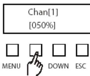
6 Une fois CHANNEL sélectionné, appuyer sur les Touches UP/DOWN pour sélectionner un Canal de 1 à 6 . Basculer sur PREHEAT , utiliser les Touches UP/DOWN pour appliquer une valeur de préchauffage comprise entre 000% et 050%.
