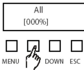
4 Dans le Mode ALL, appuyer sur les Touches UP/DOWN pour sélectionner une valeur du préchauffage comprise entre 000% et 050%.
