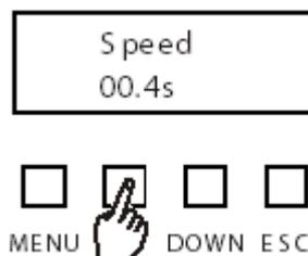
5. Sélectionner une vitesse entre 0.1 et 20 secondes entre deux pas, en utilisant les Touches UP/DOWN.
