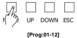
2. Drücken Sie die MENÜ-Taste, um zum Untermenü zu gelangen. Mit der UP/DOWN-Taste kann zwischen „LastHold“, „Analog“ oder „Progr:01-12“ wählen.
