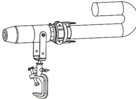
Verwenden Sie Schrauben für die Oberflächenmontage oder Klemmen für die Traversenmontage.
