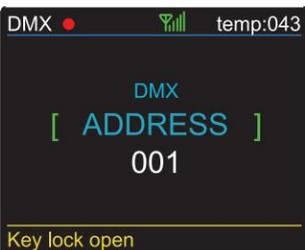
Während DMX rot, das Wireless-Signal jedoch grün angezeigt wird, bedeutet dies, dass der DMX-Modus getrennt und Wireless verbunden ist.
