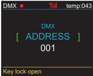
Während DMX und Wireless rot angezeigt werden, bedeutet dies, dass der DMX-Modus und Wireless nicht verbunden sind.
