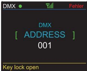
Während die Buchstaben und die Zahl „Fehler“ anzeigen, bedeutet dies, dass Temperaturprobleme vorliegen.
