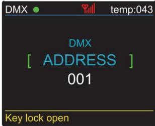
Während DMX grün, das Wireless-Signal jedoch rot angezeigt wird, bedeutet dies, dass der DMX-Modus verbunden und die Wireless-Verbindung getrennt ist.
