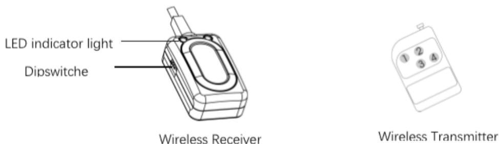
12. Stecken Sie den Empfänger in den dafür vorgesehenen Anschluss am Spark V-2. Dieser ist mit der Aufschrift „Wireless Controller“ gekennzeichnet. Die rote LED leuchtet auf, sobald der Empfänger erfolgreich angeschlossen wurde. Die grüne LED zeigt keine Funktion.
