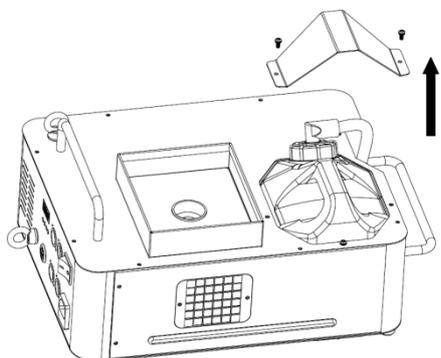
Lösen Sie die Schrauben der Tankhalterung und den Deckel des Tanks und nehmen Sie den Tank aus dem Gerät.
