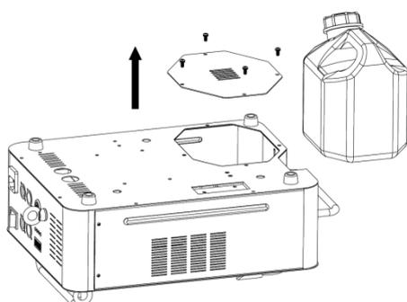
Stellen Sie die Maschine auf den Kopf und lösen Sie die Schrauben, um die Bodenplatte entfernen zu können.
