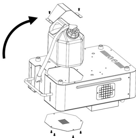
Befestigen Sie die Bodenplatte auf der anderen Seite und setzen Sie den Tank wieder ein.
