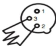
Terminatoren reduzieren Signalfehler und vermeiden Signalübertragungsprobleme und Störungen. Es ist immer ratsam einen Terminator am letzten Gerät in der Signalkette anzuschließen. (Widerstand 120 Ohm 1/4 W) zwischen Pin 2 (DMX -) und Pin 3 (DMX +).
